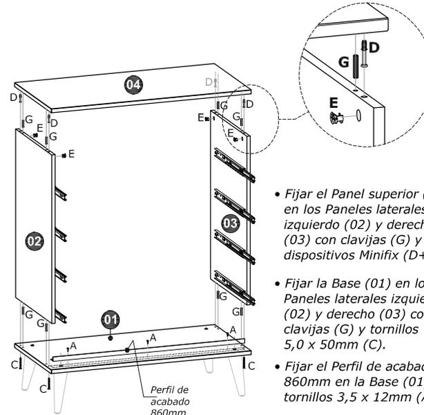
• Fijar el Panel superior (04) en los Paneles laterales izquierdo (02) y derecho (03) con clavijas (G) y dispositivos Minifix (D+E).
