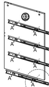
• Fijar la parte externa de las guías correderas telescópicas en los Paneles izquierdo (02) y derecho (03) con tornillos 3,5 x 12 mm (A).
