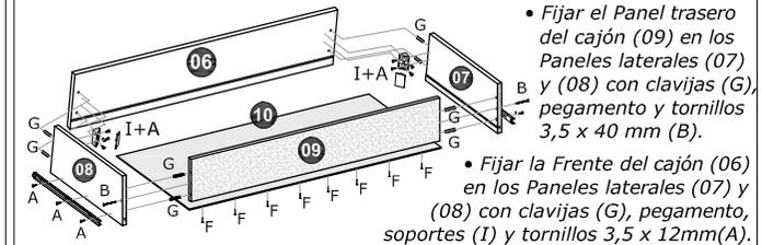
• Fijar el Panel trasero del cajón (09) en los Paneles laterales (07) y (08) con clavijas (G) y tornillos 3,5 x 40 mm (B).
