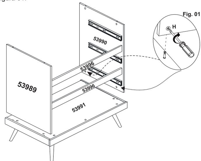
**Passo 4:** 9) fijar la tapa (53992) en las laterales (53989) y (53990). Gire los tambores minifix 15 mm "H" para fijación.
