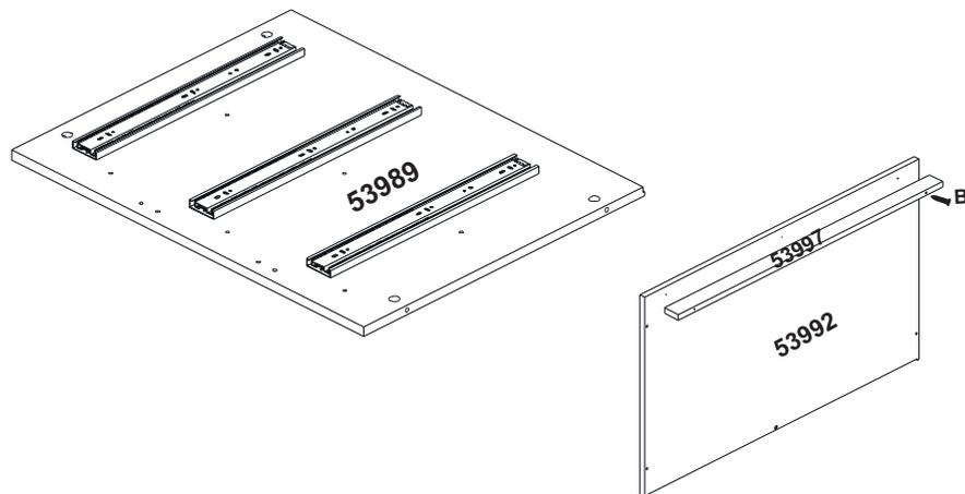
**Passo 2:** 4) Fijar las chapas de fijación en la parte inferior de la base (53991), utilizando el tornillo 4,0 x 20 c/c 'N'. En seguida roscar el pié palillo (34542) en las chapas de fijación.
